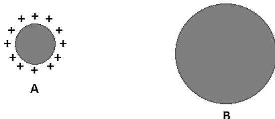
Um longo fio condutor é então usado para ligar a esfera A na esfera B e inicia-se assim uma transferência de carga elétrica.
