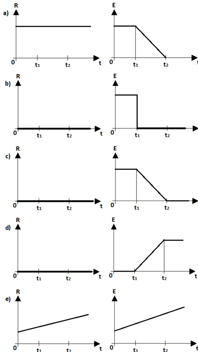
27. Um guindaste iça verticalmente uma estátua do fundo de um poço. Os valores de  $t_1$  e  $t_2$  nos gráficos das alternativas representam os instantes em que a estátua inicia e termina, respectivamente, sua emersão da água do poço. Sabendo que a velocidade de ascensão do corpo içado é considerada constante durante todo o tempo, assinale a alternativa que pode apresentar corretamente a intensidade da força resultante R e do empuxo E sobre a estátua, ambos em função do tempo t.
