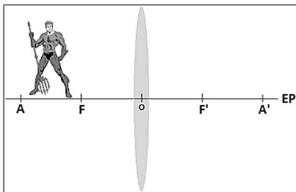
Sobre o eixo principal EP da lente, A e A' são os pontos antiprincipais, F e F' os focos principais e O, o centro óptico da lente. Sabendo que o sistema está de acordo com as condições de Gauss, a imagem conjugada pela lente na posição em que se encontra o objeto:
